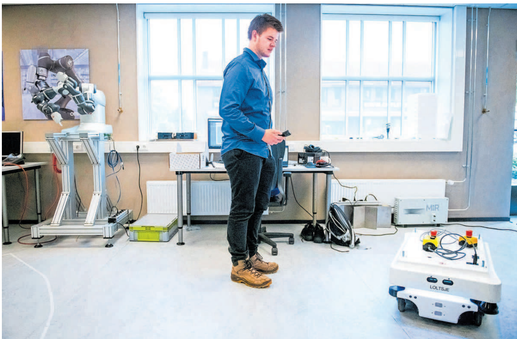
Hbo-student Justin Spethalann werkt in Skill in opdracht van Philips aan een zelfrijdend karretje dat in een fabriek onderdelen kan distribueren. FOTO'S JILMER POSTMA
